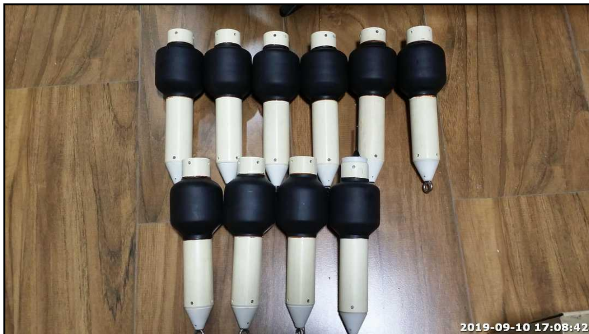
Figura 57: Fabricação de 10 terminais rastreadores utilizando tecnologias IoT.
