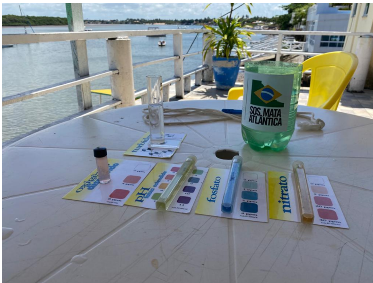
Figura 2.5.3. Kit de análise e indicadores do Índice de Qualidade da Água (IQA).
