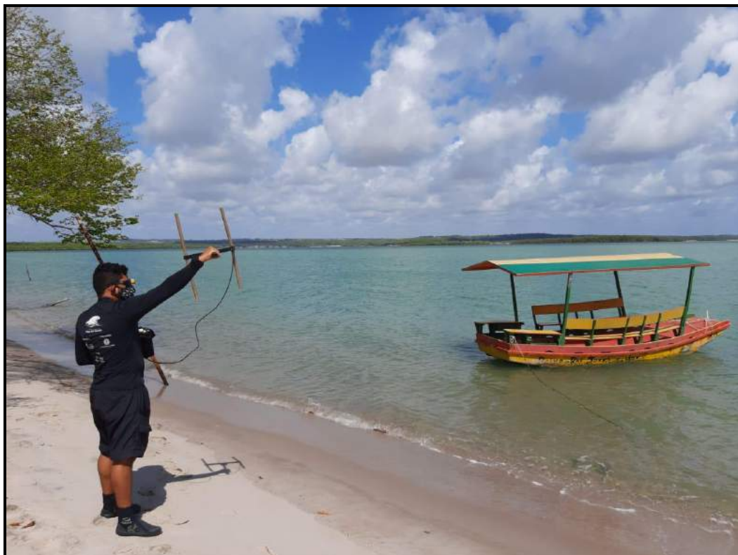
Figura 21: Captação do sinal de VHF utilizando um receiver e antena.
