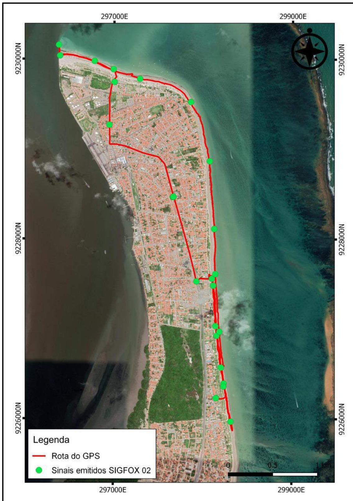
Figura 36: Teste de transmissão do dispositivo Sigfox nas praias do município de Cabedelo/PB.
