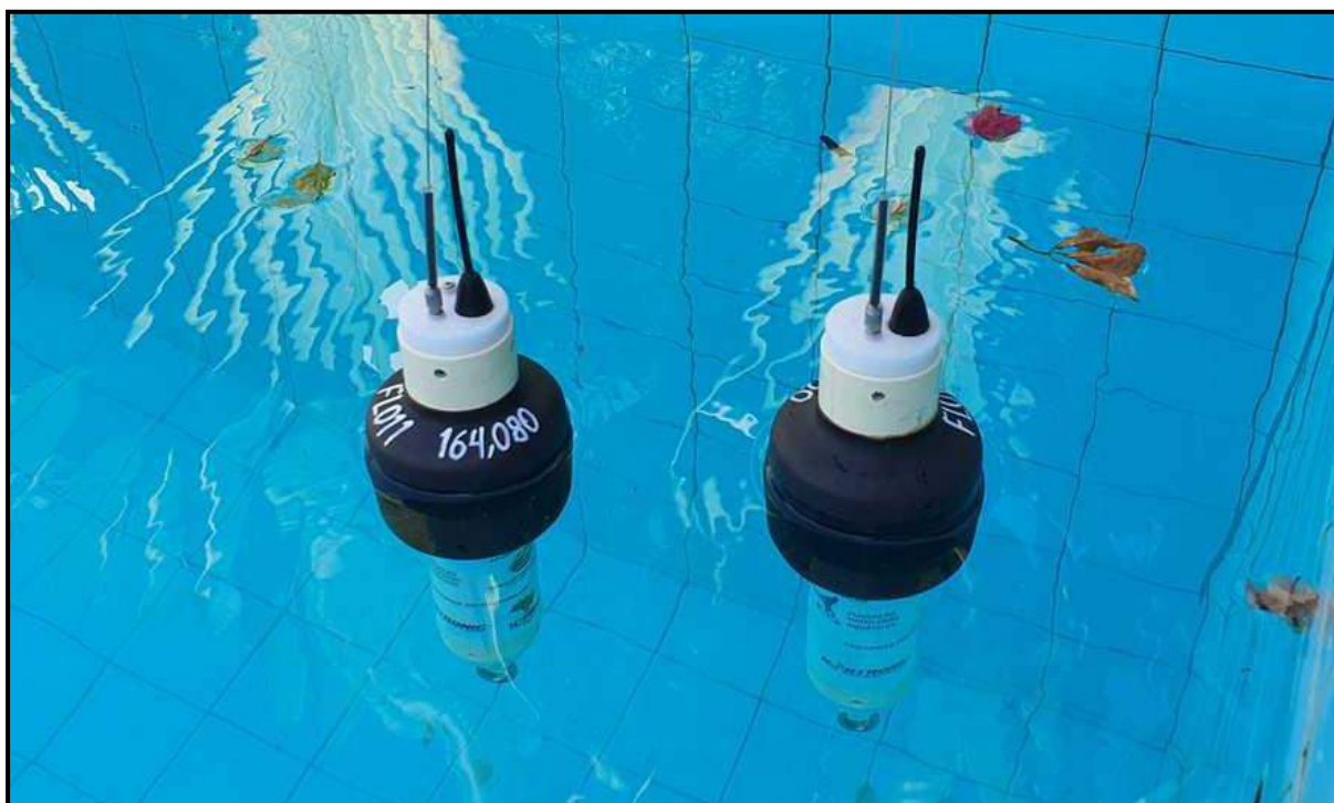
Figura 19: Testes de flutuação realizados com os equipamentos após fabricação final.
