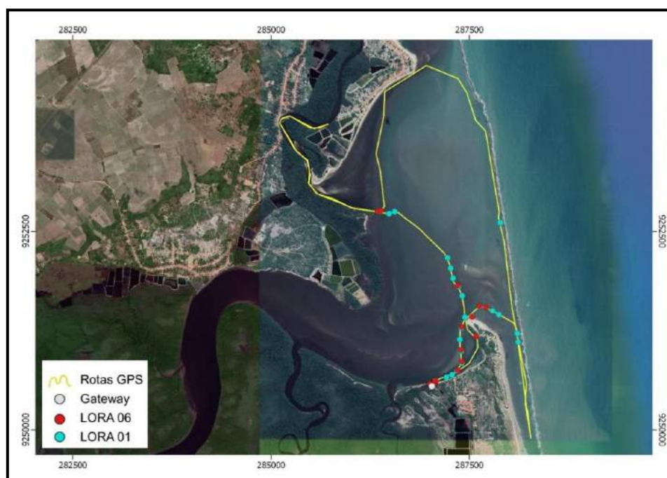
Figura 29: Testes realizados no estuário do rio Mamanguape e rio Camurupim com os transmissores LoRa (#06 e 01).
