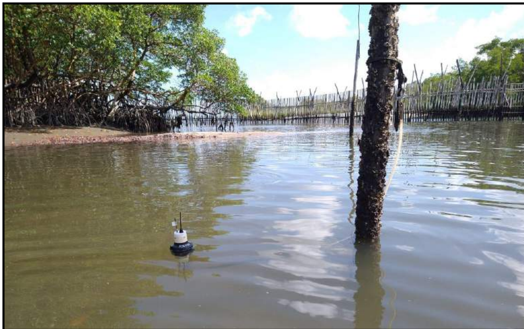
Figura 37: Dispositivo Sigfox colocado no cativeiro de readaptação dos peixes-bois-marinhos.
