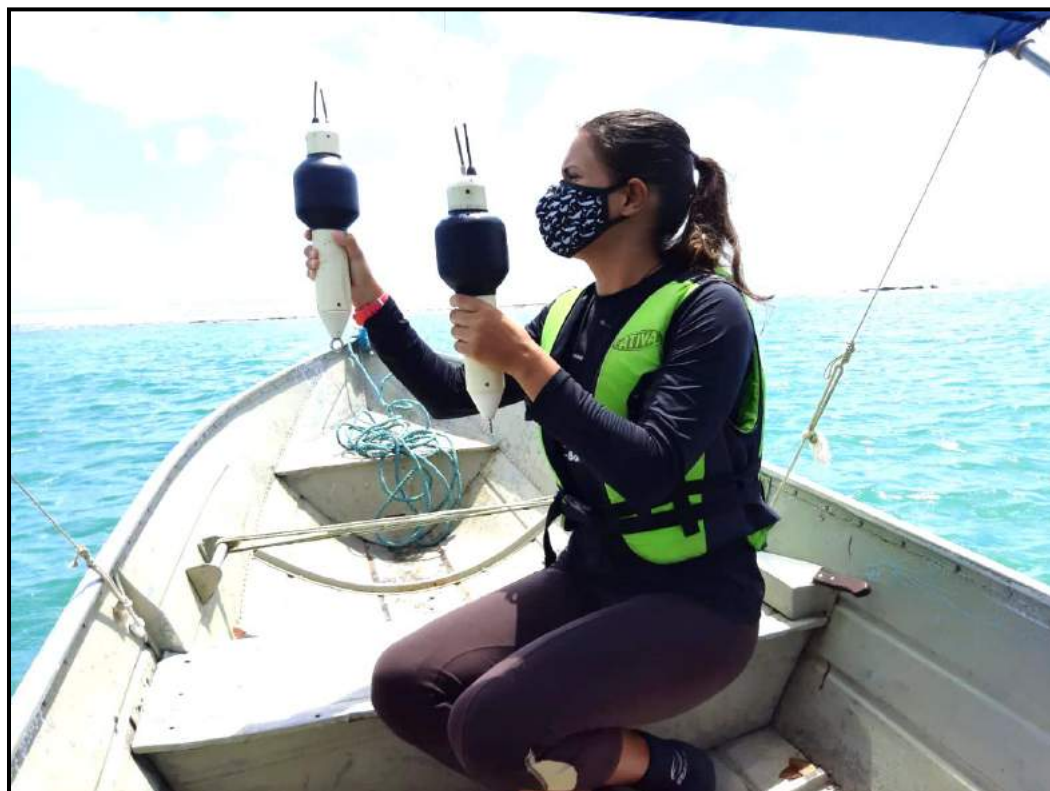
Figura 22: Transmissores a bordo de embarcações para avaliação da distância de captação dos sinais emitidos pelos equipamentos no estuário do rio Mamanguape.
