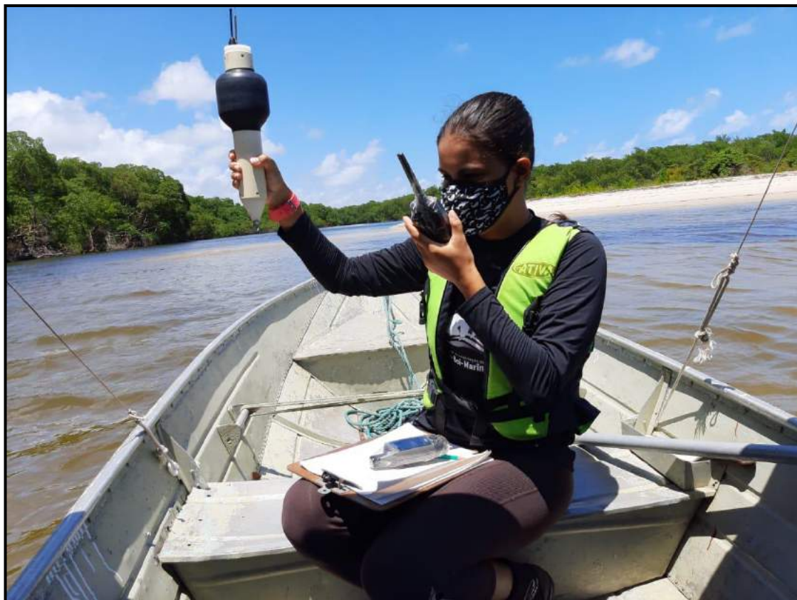
Figura 23: Comunicação via walk talk entre a equipe embarcada e de terra, com a coleta de coordenadas geográficas dos pontos de captação do sinal de VHF.
