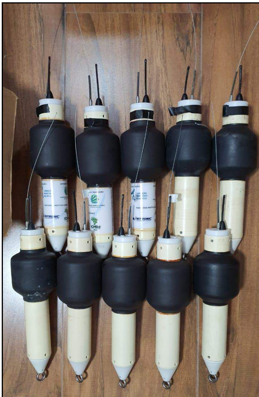
Figura 20: Fabricação dos 10 transmissores previstos, sendo cinco do sistema LoRa e cinco do sistema Sigfox.
